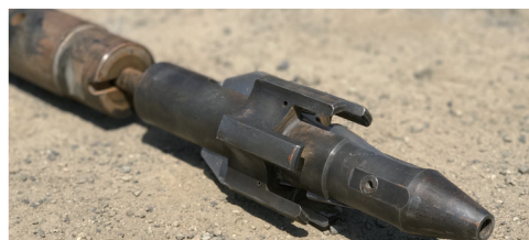
ソニックワイヤーライン オーバーショット組立 Sonic Wireline Overshot Ass'y
